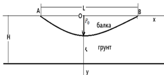
Рис. 5 Схема деформирования балки под действием сосредоточенной силы.
