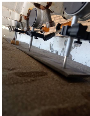
Рис. 4 Листы статического анализа для балки длиной 1 метр с песчаным основанием.
