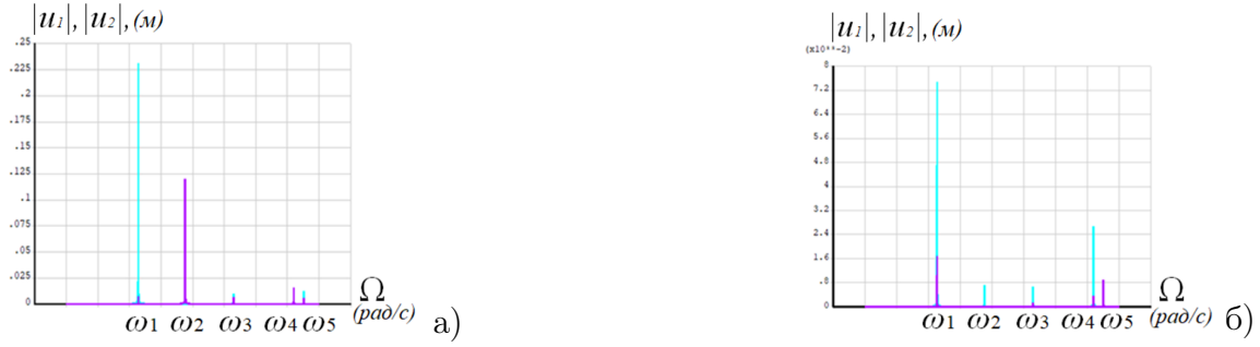
Рис. 2 Амплитудно-частотные характеристики перемещений ( |u_1|, |u_2| ) точек А – (а) и F – (б) в случае учета упругих свойств грунта для Пскемской плотины: (—) горизонтальные перемещения ( u_1 ); (—) вертикальные перемещения ( u_2 )
